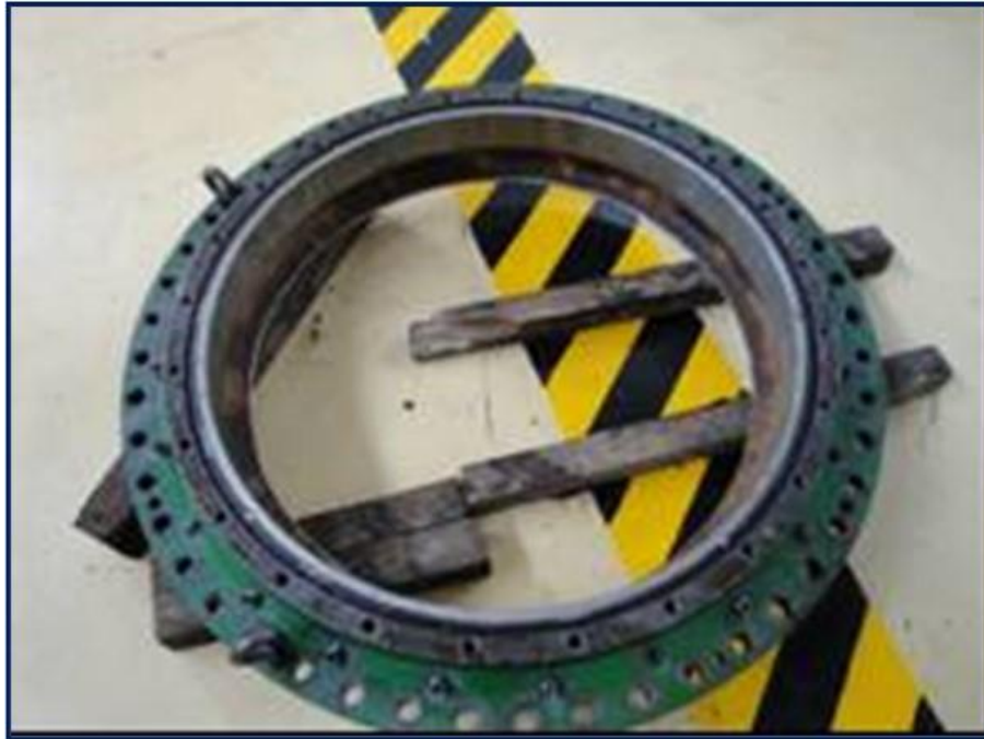
FOTO 3: Vista del plato inferior de la turbina.
