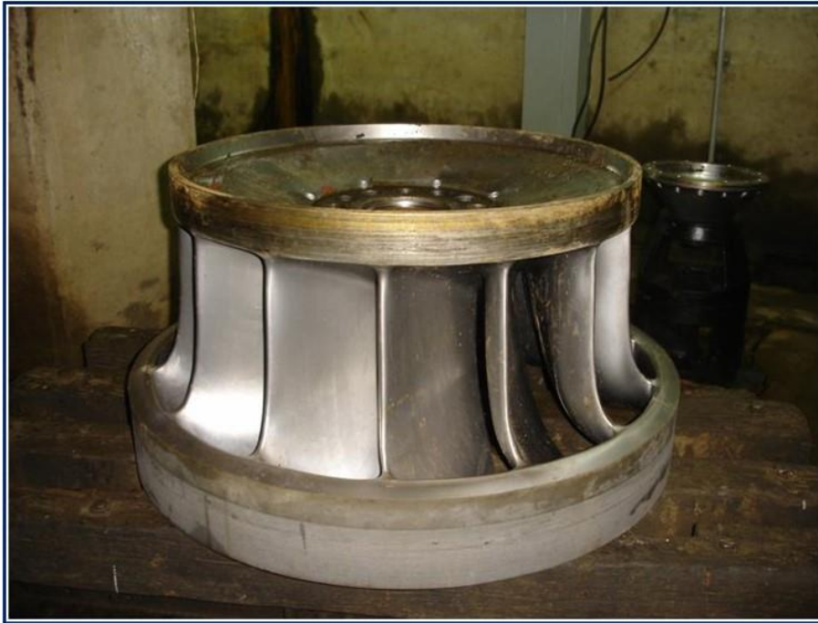
FOTO 2: Vista del plato superior de la turbina.
